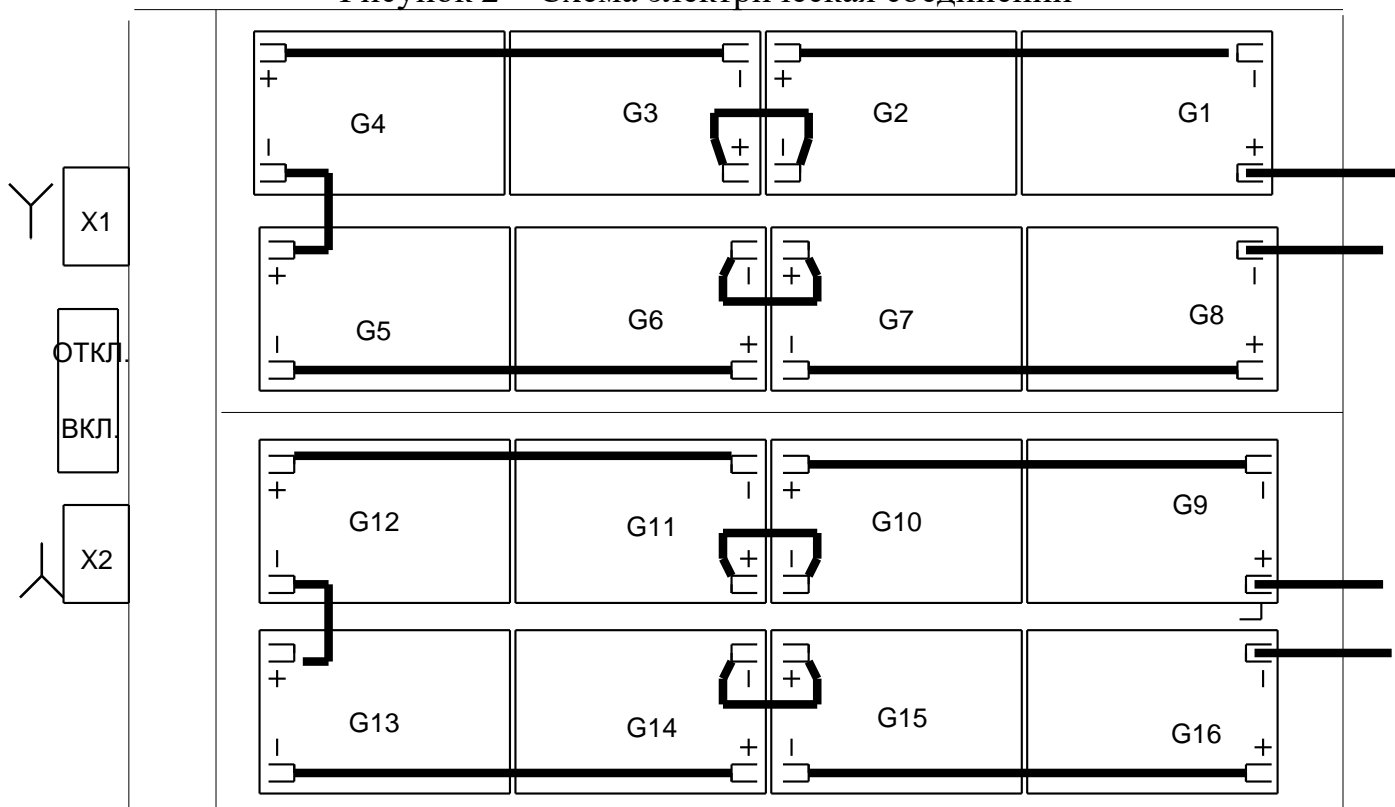
Рисунок 3 – Схема установки и соединений аккумуляторных батарей
